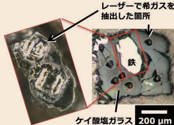
図2. マルチアンビル高温高圧実験試料の希ガス分析の様子。
