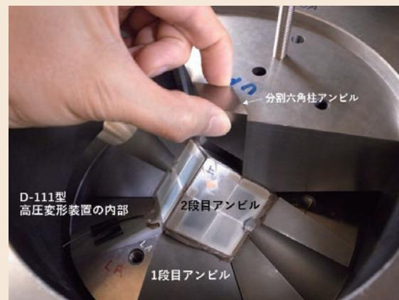
図 2. 放射光施設フォトンファクトリーのビームライン NE7A に設置された D-111 型高圧変形装置の内部。川井型マルチアンビル装置の中心部に試料を配置している。等方的に加圧した後、上下の分割六角柱アンビルを変位させて高圧下での定量的な変形実験を行うことができる。
