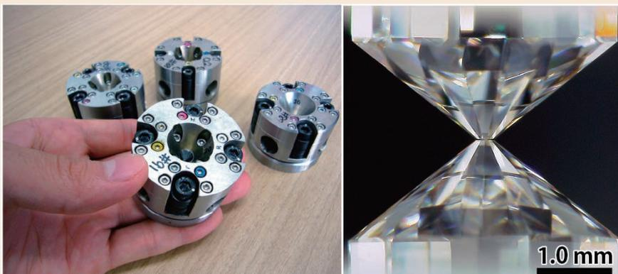
図2. ダイヤモンドアンビルセル(DAC)とその中にセットされているダイヤモンド。
