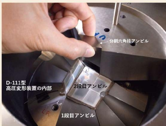
図 2. 放射光施設フォトンファクトリーのビームライン NE7A に設置された D-111 型高圧変形装置の内部。川井型マルチアンビル装置の中心部に試料を配置している。等方的に加圧した後、上下の分割六角柱アンビルを変位させて高圧下での定量的な変形実験を行うことができる。
