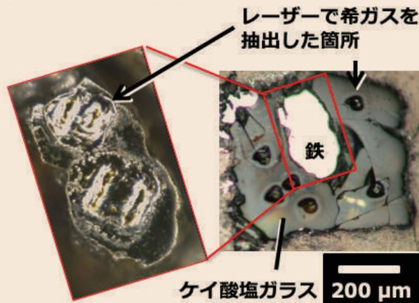
図2. マルチアンビル高温高压実験試料の希ガス分析の様子。
