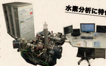
京都大学地球惑星科学専攻宇宙地球化学講座設置の同位体顕微鏡の写真。微量結晶水の分析に特化した仕様となっています。
